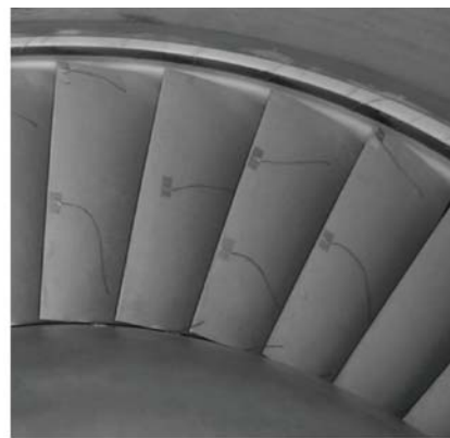
(b) 轮毂和叶片吸力面上的示迹线 (从转子进口看)
